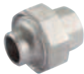
Driedelige koppeling - bolconisch dichtend - las x BSP female
